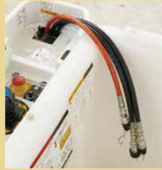
》 上部油圧取出口 OP 作業床にて油圧動力の取り出しが可能
