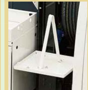
》 セーフティーコーン収納 OP 最大10個まで搭載可能
