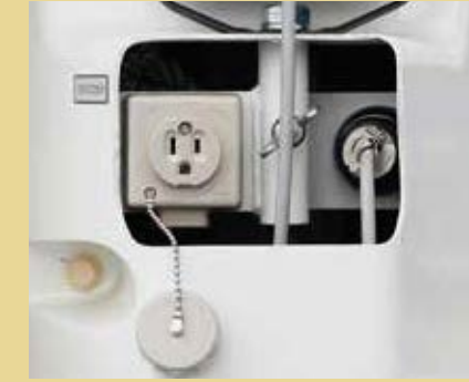
》 100V電源取出口 OP 発電機を接続することで、作業床にて100V電源取り出しが可能
