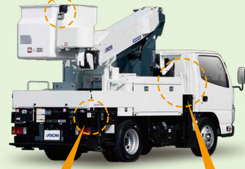
》 100V電源取出口 OP 発電機を接続することで、作業床にて100V電源取り出しが可能
