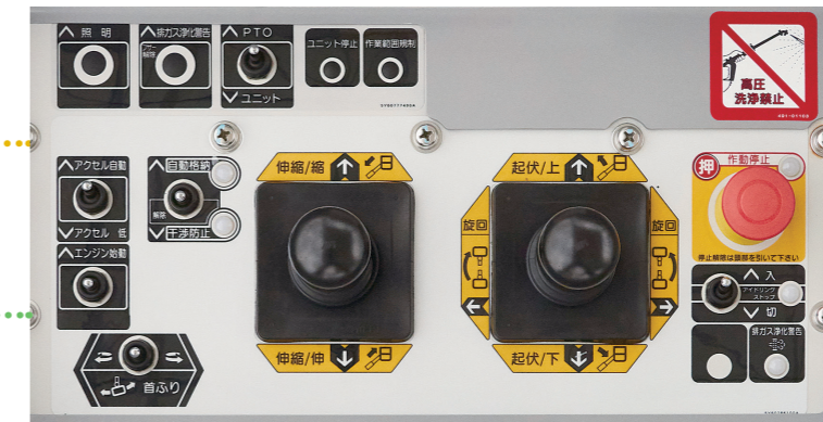
2軸+1軸ジョイスティック(イネーブルスイッチ付き)
