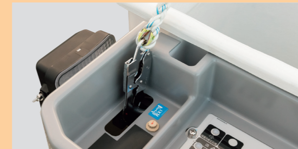
≫墜落制止用器具取付確認装置 OP 墜落制止用器具フックを所定の掛け箇所にかけていない場合に架装部操作を規制
