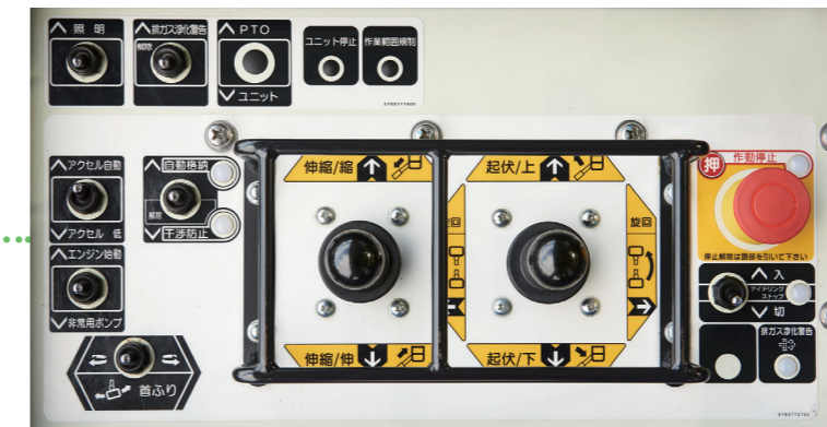
2軸+1軸ジョイスティック(フートスイッチ付き)
