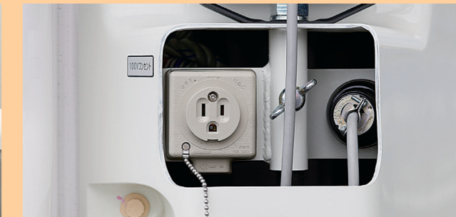
≫100V電源取出口 OP 電源を接続することで、作業床で100Vの取出しが可能
