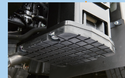
≫ゴム付きパッドベース OP ジャッキ張出時の路面傷付けリスクを低減
