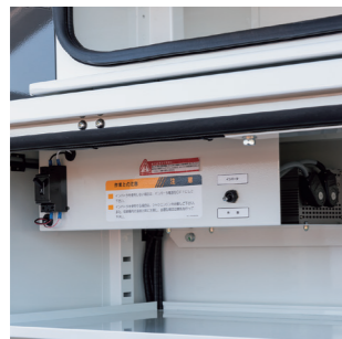
≫インバーター OP シャシーバッテリーやバッテリーユニットから100V電源の取出しが可能
