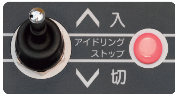
一定時間操作しないとエンジンが停止します
